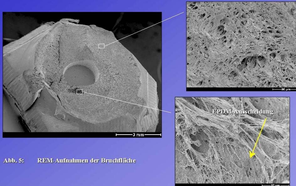
Abb. 5: REM-Aufnahmen der Bruchfläche
