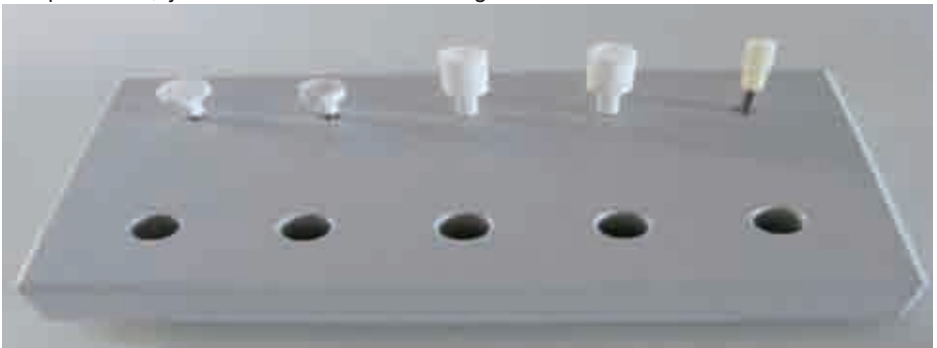
Abb. 1: Al_2O_3 -Tiegel-Sortiment: Plattform, kurzer DTA-Tiegel, Standard-DTA-Tiegel, gelochter DTA-Tiegel, Mini-DTA-Tiegel (v.l.n.r.)
